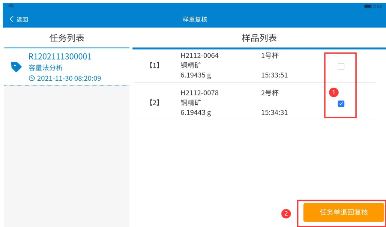
选中需要复核的数据，点击【任务单退回应核】，复核样品就返回到了【样品称重】环节，进行复核称重。
