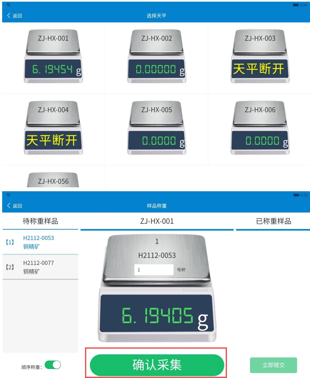
数据不稳定时，仪表上的数据显示黄色，不能点击【确认采集】。数据稳定后，仪表上的数据显示绿色，可点击【确认采集】按钮。注：每次称重后仪表上的数据必须回零后才能继续数据采集。
