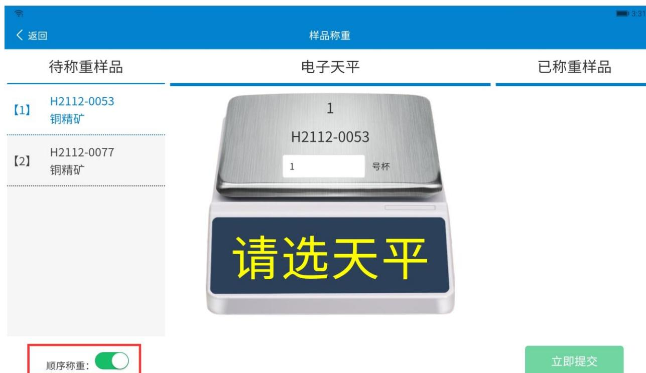
2、称重区：天平上显示称重顺序号、样品编号、样品杯号、称重比例、天平重量。在称重前，需要点击“请选天平”，选择本次称重天平。说明：杯号系统按顺序自动生成，如果杯号有变动的，可进行修改，如果是筛上筛下样品，需在称重比例处，录入比例数据。
